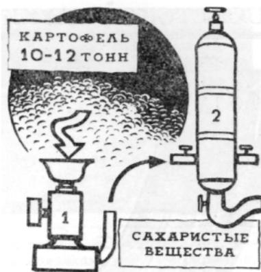
Схема получения спирта из картофеля и из древесных опилок. Картофель поступает в специальную машину для его измельчения и извлечения крахмала (1). Затем производится осахаривание крахмала (2). Сахаристые вещества направляются в чан брожения (3), а после разгонки (4) выходит чистый спирт (5).
